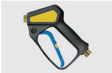
Professionelle Pistole. Weepausführung. Max. 310 bar / 45 l/min / 150 °C
