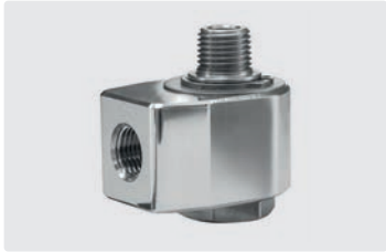
1/4" IG : 1/4" AG. DN 7. Max. 275 bar / 30 U/min / 120 °C
