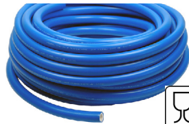
Högi Thermoclean 100 bis zu 100°C Temperatur kurzzeitig 120°C. Arbeitsdruck bis 30 bar. Lebensmittelzulassung 10/2011 A/B/C. Fördern von Lebensmitteln als auch Reinigungswasser
