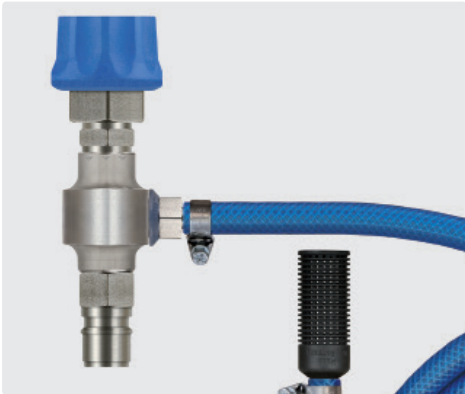
Kupplung ST-45-250 Edelstahl : Stecknippel ST-45-250 Edelstahl. Injektor mit Saugschlauch 2000 mm und Saugfilter ST-31. Regulierung der Chemiedosierung erfolgt durch 8 auswechselbare Dosiereinsätze (0,5 - 1,5 mm). Max. 250 bar / 90 °C
