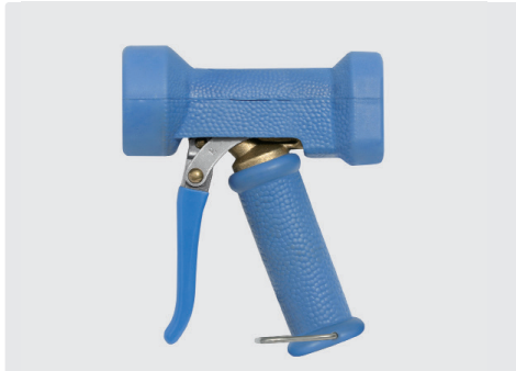
Pistole mit stufenloser Spritzwinkelveränderung. Max. 24 bar / 100 l/min / 50 °C
