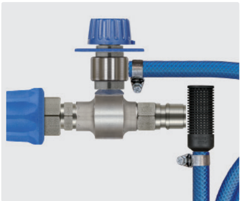
Kupplung ST-45-250 Edelstahl : Stecknippel ST-45-250 Edelstahl. Injektor mit Dosierventil ST-161, Saugschlauch 2000 mm und Saugfilter ST-31. Max. 250 bar / 90 °C
