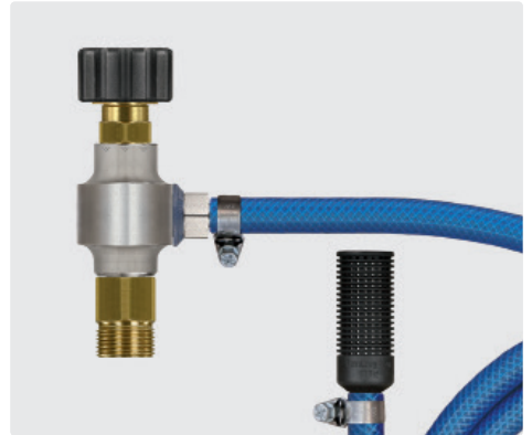
HV M22 : M22 AG. Injektor mit Saugschlauch 2000 mm und Saugfilter ST-31. Regulierung der Chemiedosierung erfolgt durch 8 auswechselbare Dosiereinsätze (0,5 - 1,5 mm). Max. 350 bar / 90 °C
