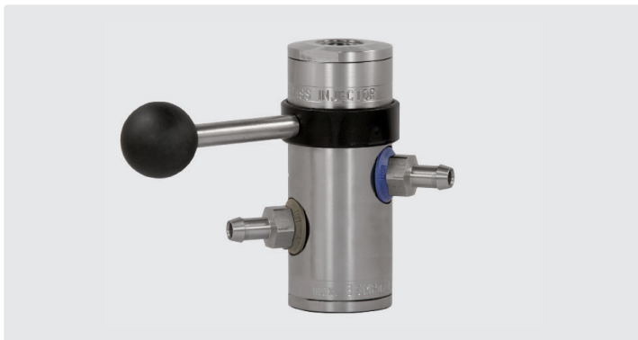
1/2" IG : 1/2" IG. Injektor mit Tülle 9 mm und Druckluftmodul (Tülle 9 mm). Regulierung der Chemiedosierung erfolgt durch 8 auswechselbare Dosiereinsätze (0,5 - 1,5 mm). Max. 350 bar / 100 °C
