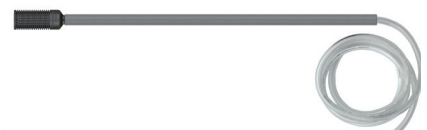
Ansaugset mit Saugschlauch 1500 mm, Ansaugfilter ST-31 und chemikalienbeständiges Kunststoffrohr 320 mm. Das Rohr hält den Ansaugfilter an der tiefstmöglichen Position.
