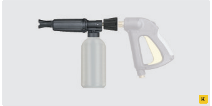
HV M22 drehbar. Schauminjektorlanze mit Dosierung und Flasche. Max. 250 bar / 80 °C
