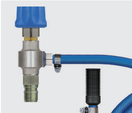
Kupplung ST-45-250 Messing vernickelt : Stecknippel ST-45-250 Stahl verzinkt. Injektor mit Saugschlauch 2000 mm und Saugfilter ST-31. Regulierung der Chemiedosierung erfolgt durch 8 auswechselbare Dosiereinsätze (0,5 - 1,5 mm). Max. 250 bar / 90 °C
